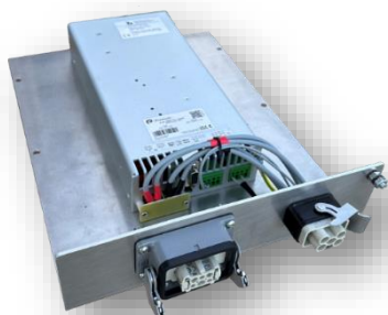
Bild: Individualisierung mit Montageplatte und mit bahnüblichen Kontakten adaptiert.
