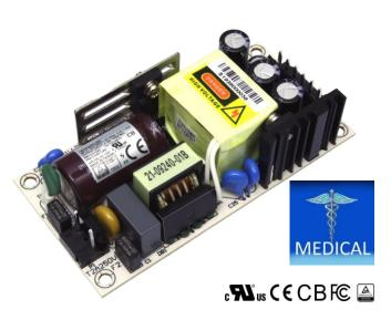
Bei der OFM100S Serie handelt es sich um eine Serie sehr kompakter AC/DC Netzgeräte mit einem Weitbereichseingang von 80VAC bis 275VAC. Die Geräte haben Einfachausgang und eine maximale Ausgangsleistung von bis zu 100 Watt bei einem Wirkungsgrad von bis zu 86% auf einer kompakten 2"x 4" Leiterplatte
